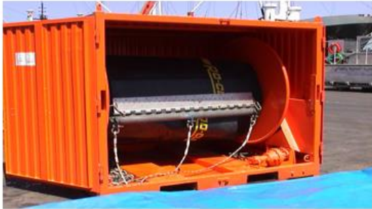
Le dispositif de récupération des hydrocarbures (OMMP, 2015)
