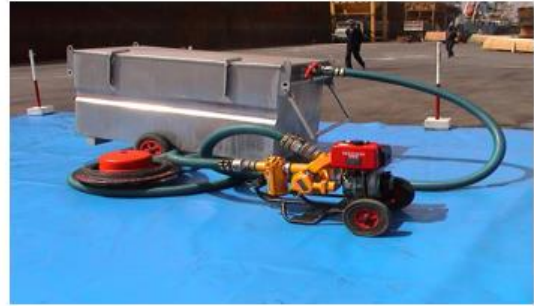
| La pompe de récupération (OMMP, 2015)
