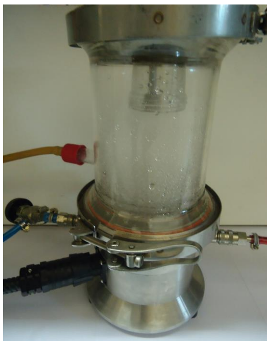
Figure II. 5. Photographie du générateur d'aérosol en fonctionnement à une puissance de 33W et une fréquence de 1,1 MHz.
