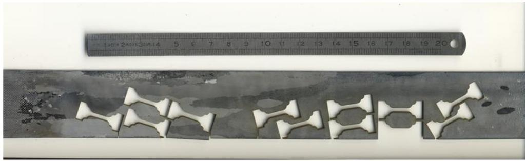
Figure II. 10 : Exemple de plaque multicristalline de fer et les découpes d'éprouvettes de traction
