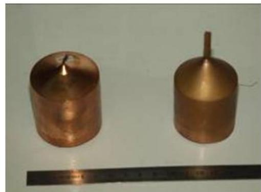
Figure II.1. : *Four Bridgman (gauche) et monocristaux de cuivre (droite)*
