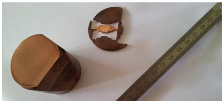
Figure II. 9 : Exemple de monocristal de Cu et les découpes d'éprouvettes de traction
