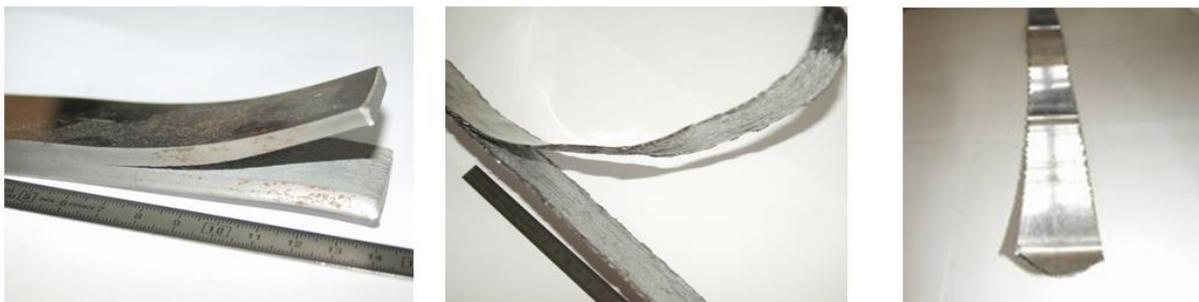
Figure II.3. : Crocodiling en laminage intense de lopins de ferrite
