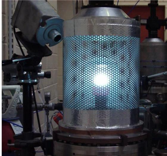
Figure 13: photographie du réacteur Bell-Jar utilisé au LSPM (ex LIMHP)
