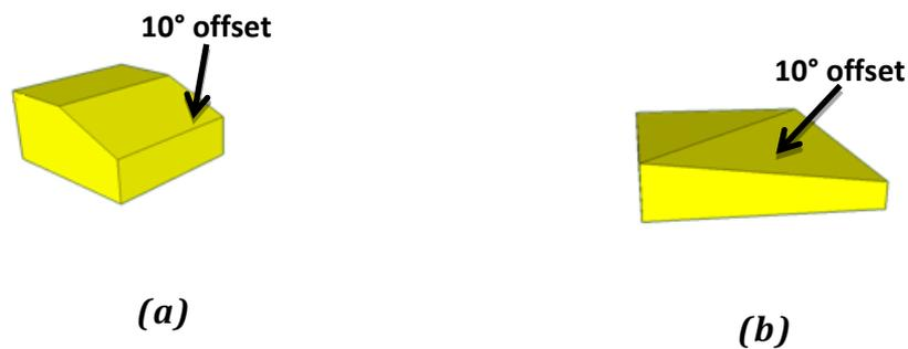
**Figure V- 5: schémas des substrats HPHT (a) G avec un biseau de  $10^\circ$  le long de la direction  $[100]$  et (b) H avec un biseau de  $10^\circ$  selon la direction  $[110]$ .**
