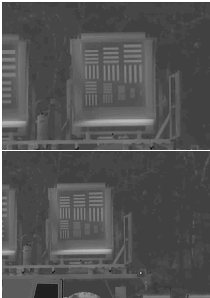
Figure 4.29 – Effet cartoon de la régularisation non quadratique sur la mire à bâton de la séquence Camion : en bas réglage de seuil amplifiant cet effet, la mire numéro 6 commence à devenir non résolue. Les paramètres de traitement sont donnés en Table B.3 .
