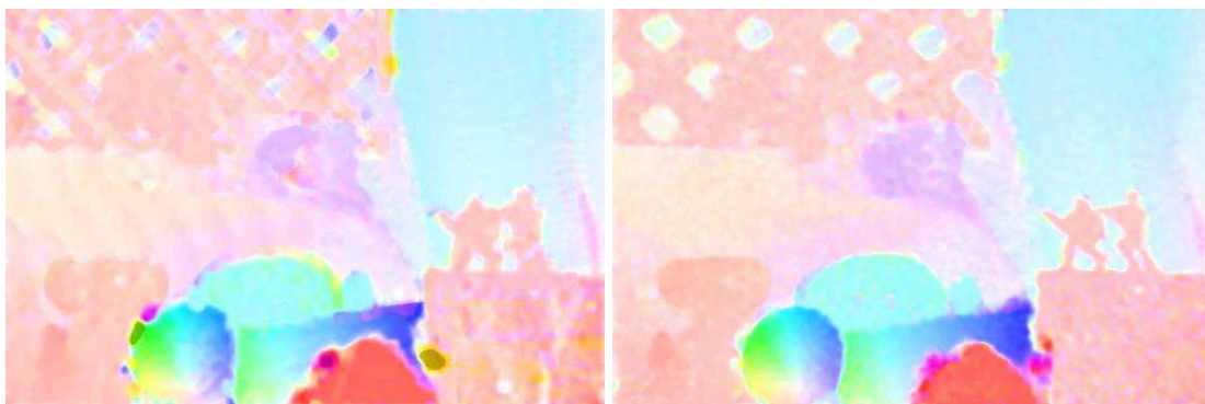
Figure 3.15 – Réduction de l'empâtement des objets par la transformée Rank. A gauche, résultat de FOLKI (fenêtre gaussienne d'écart-type 2.5) sur l'exemple Army ; à droite, même algorithme appliqué à l'image issue d'un Rank-4. Les images de flot utilisent le codage en couleur du site Middlebury avec un déplacement max de 5 pixels.
