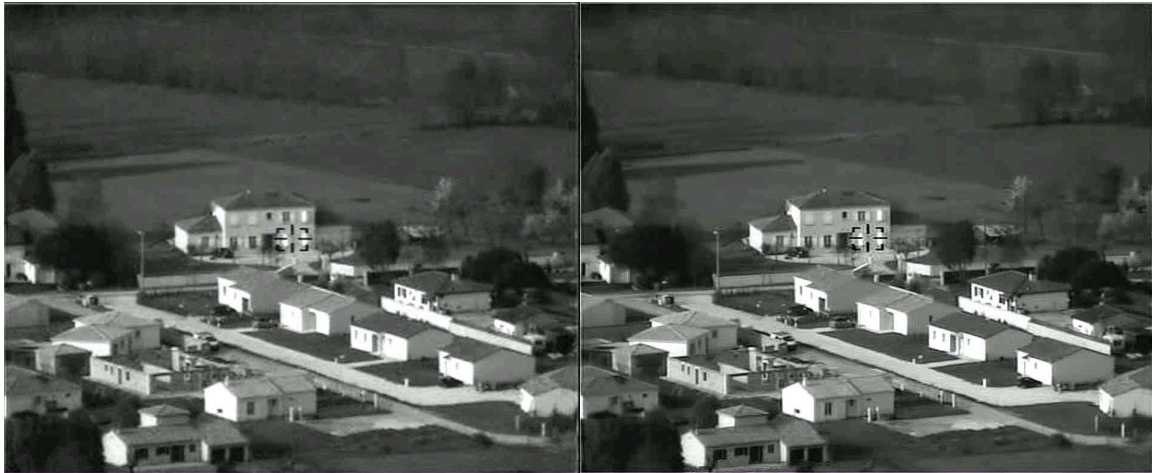
Figure 4.43 – Comparaison image BR et image SR avec régularisation non quadratique sur la régularisation et les données pour la séquence Aerial1. Les paramètres de traitement sont donnés en Table B.3.
