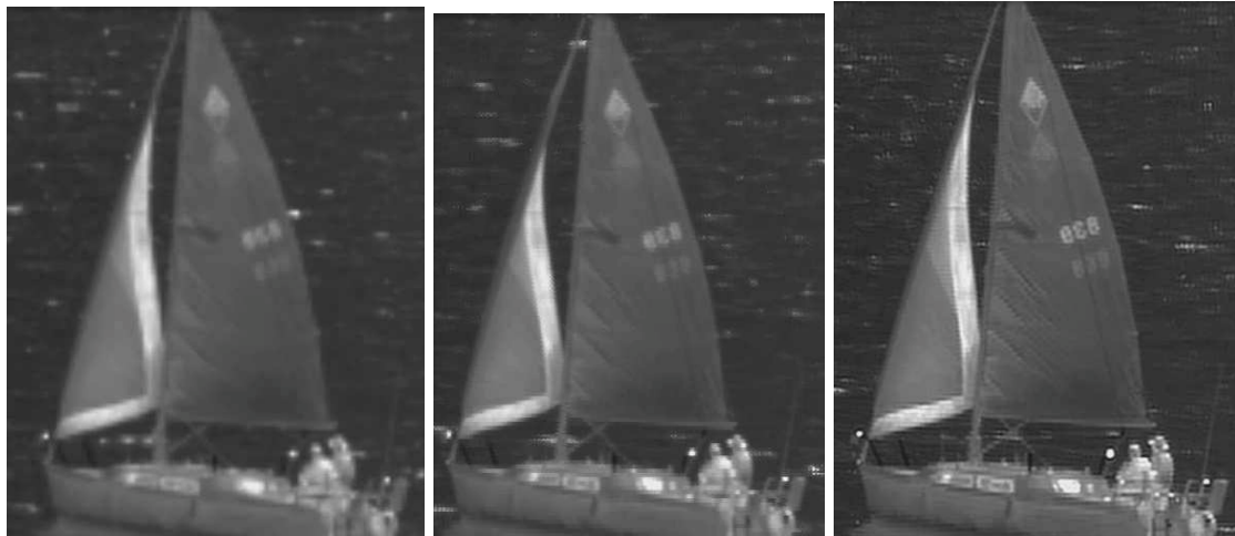
Figure 4.10 – SR rapide sur la séquence Voilier. De gauche à droite : image BR originale mise à l'échelle par interpolation bilinéaire (facteur de SR 5.5), Shift and mean avec bouchage de trous (SM), et Shift and mean et déconvolution par Small Kernel (SMSK). Les paramètres sont en table B.3.
