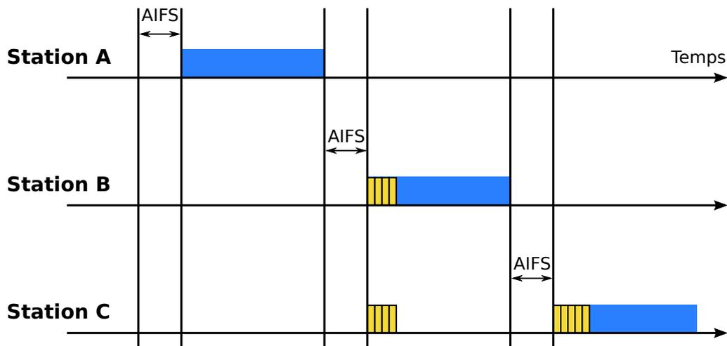
FIGURE 2.9 – Mécanisme d'accès EDCA pour trois diffusions
