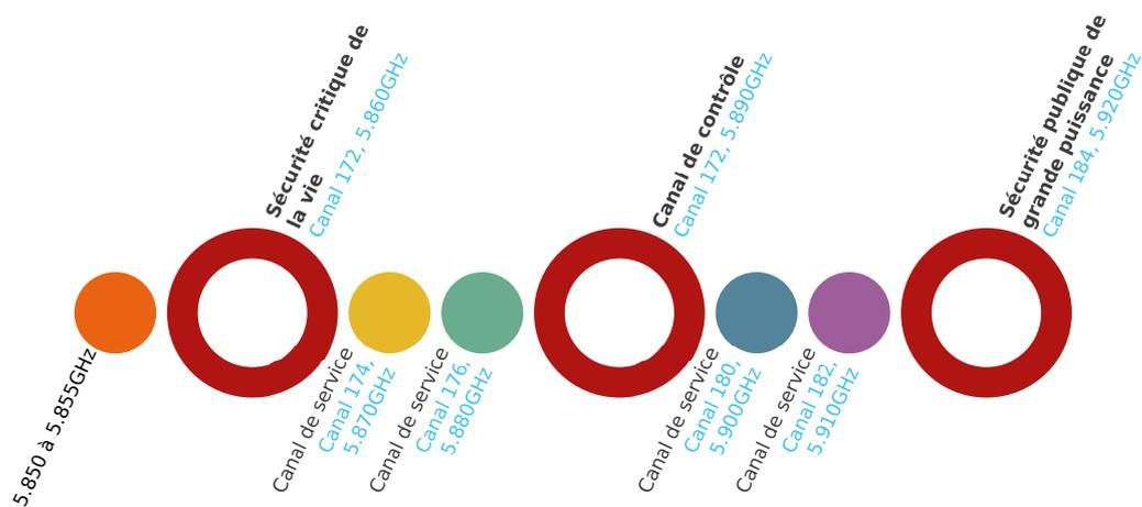
FIGURE 2.7 – Distribution du spectre DSRC en canaux aux USA
