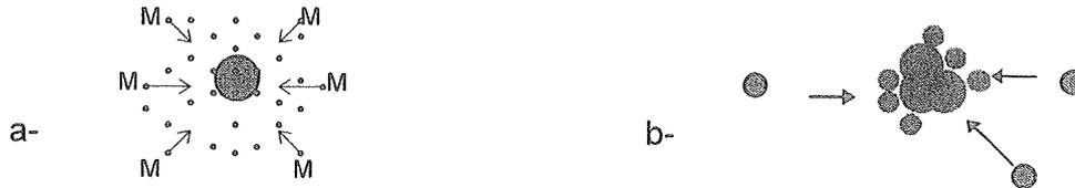
**Figure I.1. : Croissance des particules (a) par addition successive de monomères (diffusion) et (b) par agrégation de particules primaires [38]**
