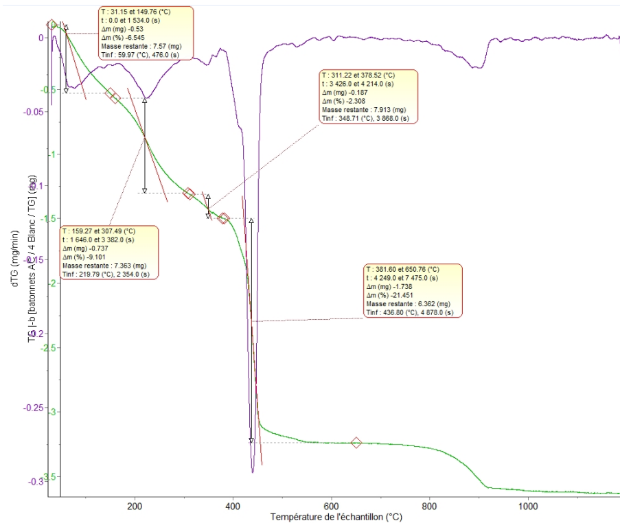
Figure 2 : Courbe ATG des nanobâtonnets fonctionnalisés par l'acide caféique
