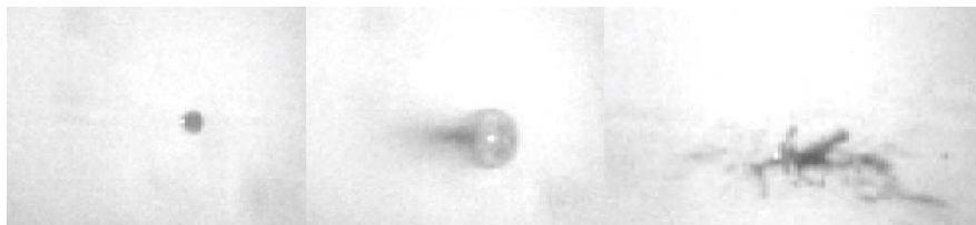
Figure 5: Images de la goutte à l'air libre avant, 2 \mu\text{s} et 20 \mu\text{s} après l'absorption du faisceau IR.
