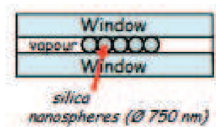
Figure c-1 : Schéma de la cellule contenant une opale monocouche emprisonnée entre les deux fenêtres, imaginée par le groupe en 2007 [ROM].
