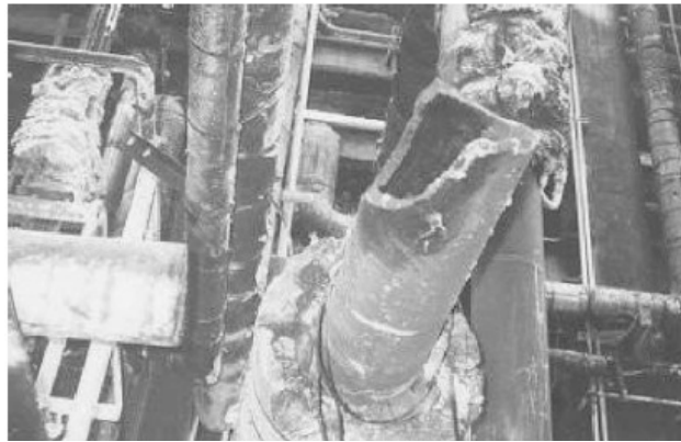
Figure 1. La rupture dans un tube exposé à l'hydrogène [1]
