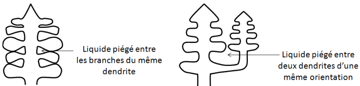
Figure 58 : Schéma de croissance dendritique expliquant la précipitation intragranulaire
