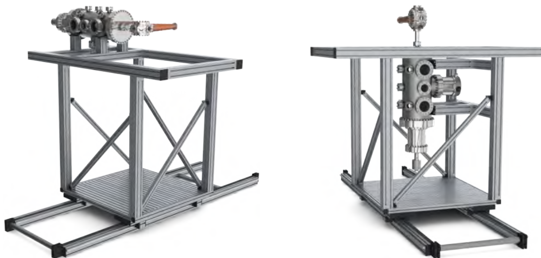
FIGURE 3.1 – Configurations pour un jet atomique horizontal (à gauche) ou vertical (à droite) — En plus du châssis, sont illustrées la deuxième partie du ralentisseur Zeeman ainsi que les enceintes à vide du MOT et d'expériences
