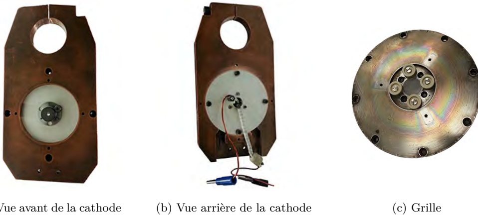
FIGURE 1.3 – (a) cathode sur son isolant en nitrure de Bore (en blanc) et (b) connectée avec deux fils de tungstène isolés par des céramiques, et (c) grille en molybdène maintenue par des céramiques et des vis en molybdène
