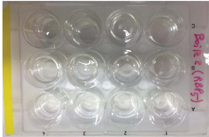
Figure II-10. Préparation des films polymères pour les tests de morphologie (observation de comportement) et de la prolifération cellulaires.
