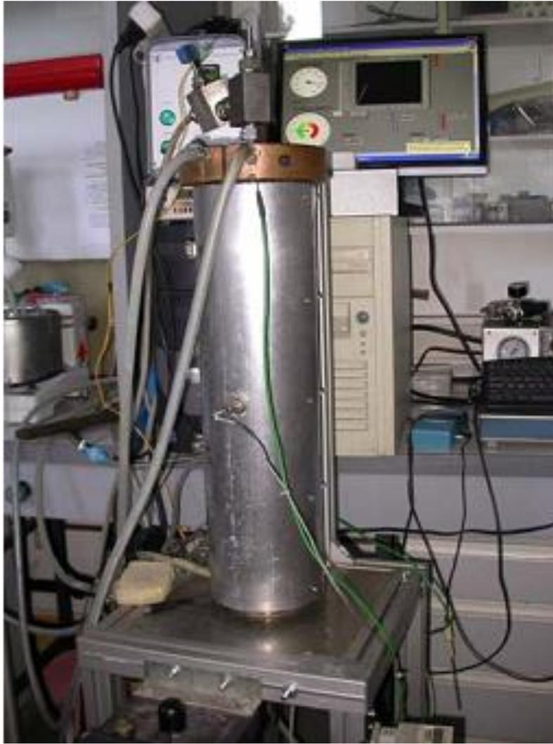
**Figure 27 : Autoclave artisanal du laboratoire**
