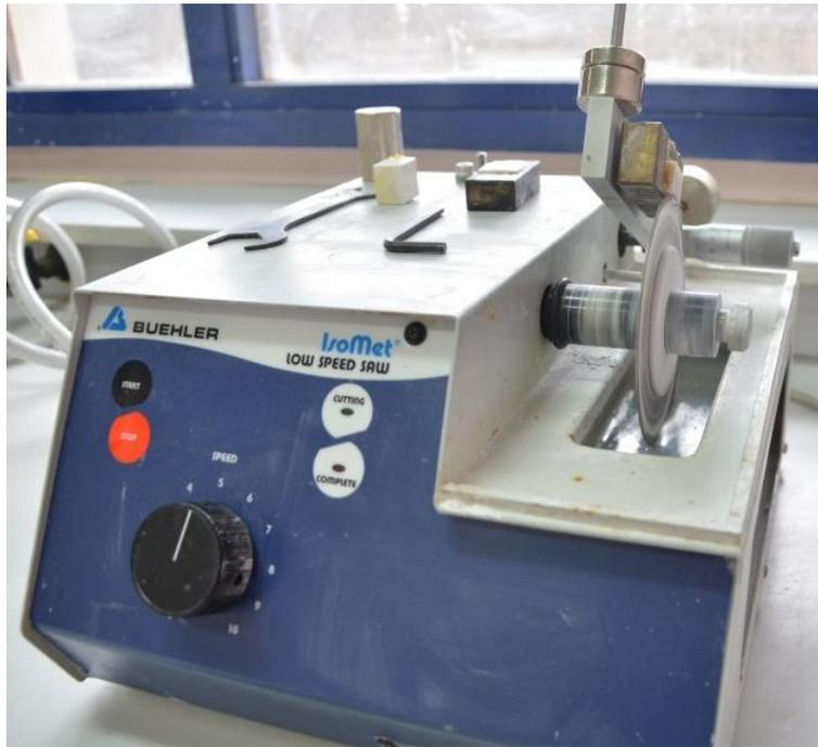
**Figure 208 : Scie tronçonneuse Isomet (Buehler)**
