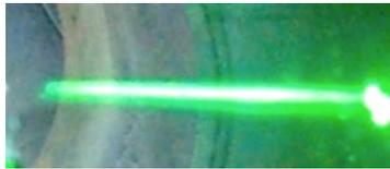
**Figure IV.1.** Image de la diffusion du faisceau laser dans le nuage de particule. *Ce faisceau intense correspond à l'image de la diffusion des poussières*
