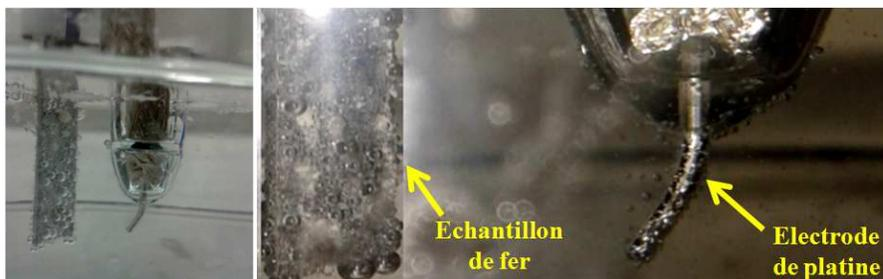
Figure II.27. Observation de l'électrode de platine et l'échantillon de Fer au cours de chargement cathodique.
