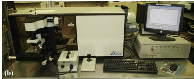
Figure II-11 : (a) Schéma d'un dispositif de spectrométrie Raman [115], (b) Spectromètre HR-800 du LSPM.
