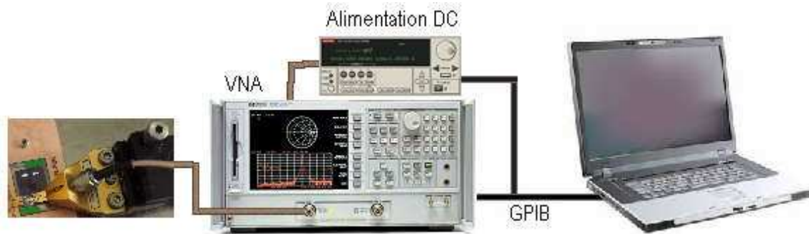
Figure 3.17 : Mesure d'impédance Analyseurs de réseaux HP 8753E / Source de tension continue Keithley 2635A
