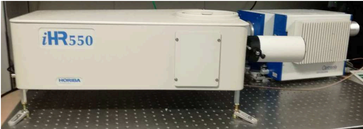
Figure 3.19 : Spectromètre à réseau HORIBA iHR 550 de Jobin-Yvon
