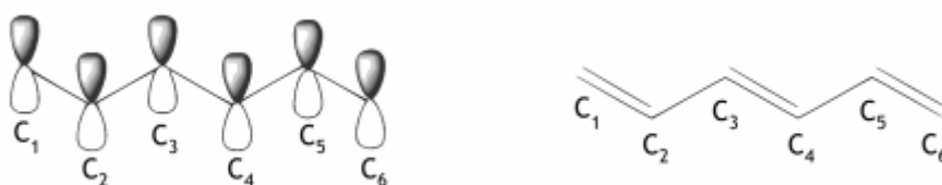
Figure 1.4 : (a) Chaîne de carbones hybridés sp^2 (b) Représentation conventionnelle d'une chaîne \pi -conjuguée.
