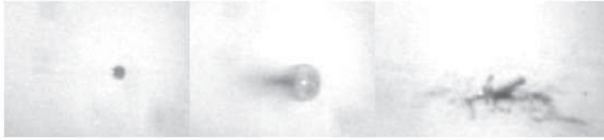
FIGURE 2.19 – Explosion d'une micro-gouttelette. A gauche interaction avec le laser à t = 0 \mu\text{s} , au milieu à t = 2 \mu\text{s} , à droite à t = 20 \mu\text{s} . t représente le temps s'étant écoulé depuis l'envoi de l'impulsion laser.
