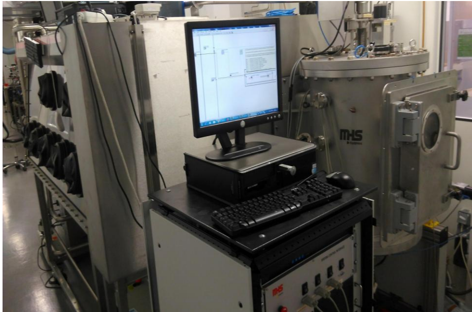
Figure 2.1 : Commande électronique (à gauche), bâti d'évaporation (à droite) associé à une boîte à gants (derrière).
