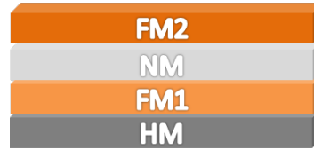
FIGURE 3.17 – Système d'empilement de couche composé de deux couches ferromagnétiques différentes (FM1 et FM2) séparées par un espaceur non-magnétique (NM) et déposées sur une seule couche de métal lourd (HM) afin d'induire la DMI.
