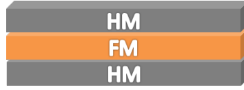
FIGURE 3.7 – Système composé d'une couche ferromagnétiques (FM) placée entre deux couches de métal lourd (HM) afin d'induire la DMI aux deux interfaces.
