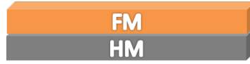
FIGURE 3.6 – Système de bicouche composé d'une couche ferromagnétique (FM) déposée sur une couche de métal lourd (HM) afin d'induire la DMI.
