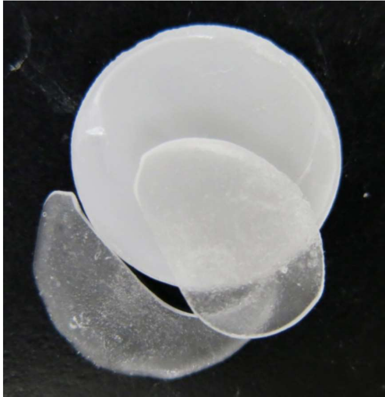
Figure 34 : Photographie d'un échantillon fracturé (VM7/Y-TZP). L'armature zircone est en arrière-plan, encore recouverte d'une couche d'émailage. Deux fragments de céramique se sont détachés au premier plan.
