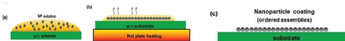
Figure IV.5: schéma du procédé de dépôt par drop coating.
