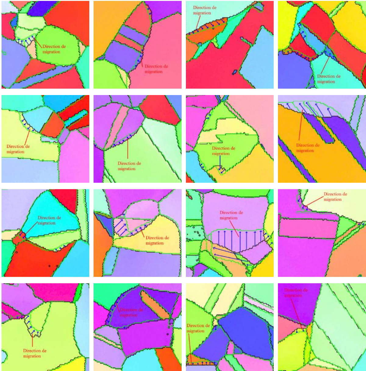
Figure IV-20 : Cartographies EBSD de taille 100\mu\text{m} \times 100\mu\text{m} obtenues par superposition des contours de grains des cartographies EBSD obtenues après recuit sur les cartographies EBSD obtenues avant recuit.
