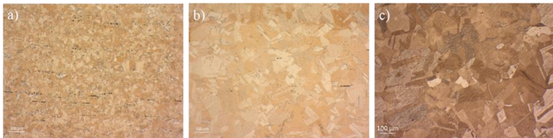
Figure III-13 : Micrographie du cuivre I recuit dans un four sous vide secondaire, a) état brut, recuit à b) 500°C pendant 1 heure et c) 800°C pendant 6 heures.
