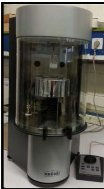
**Figure 28 : Photographie du tensiomètre à balance de Wilhelmy**
