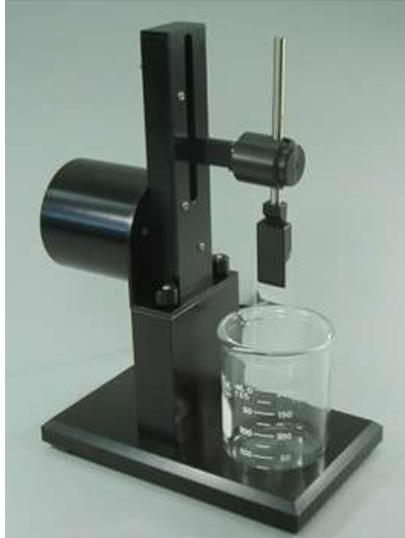
**Figure 31 : Photographie du *dip coater***
