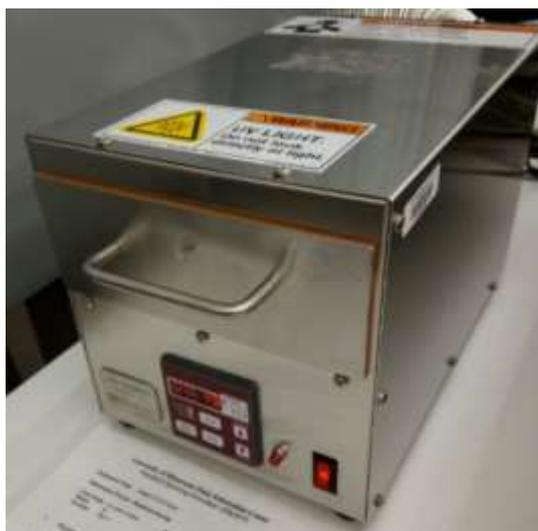
**Figure 29 : Photographie du nettoyeur UV/O<sub>3</sub>**
