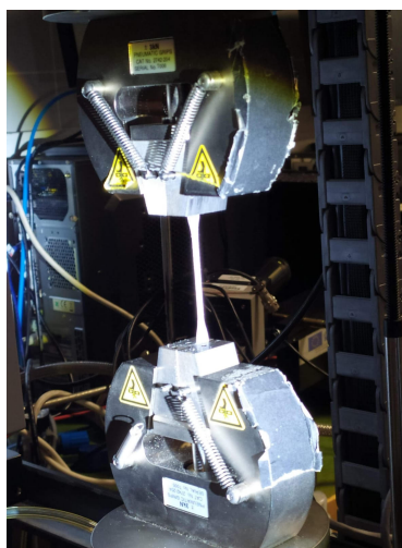
Figure 31: Montage d'un test de traction uni axial
