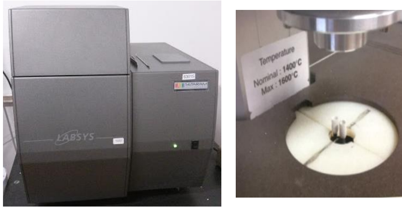
Figure 2.6 - a: Image de l'appareil ATD/ATG; b: Image des creusets en alumine utilisés
