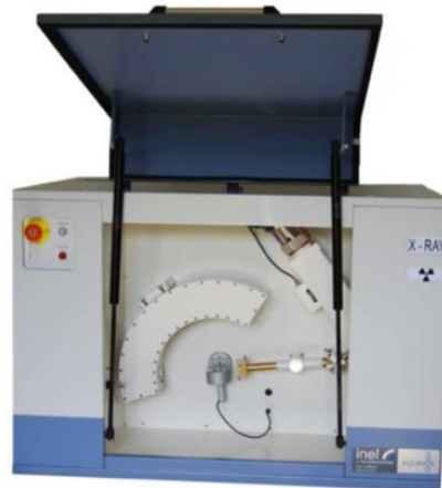
Figure 2.2 - Image du diffractomètre INEL Co Equinox 1000 [Ine18]
