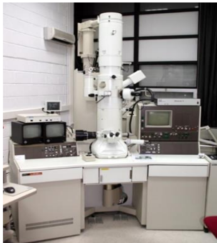
Figure 2.5 - Microscope électronique en transmission présent au LSPM (modèle MET 200 KV JEM 2011 (JEOL, 2004))
