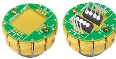
Figure 2.21 - Modèle du Puck utilisé pour la mesure de la résistivité électrique
