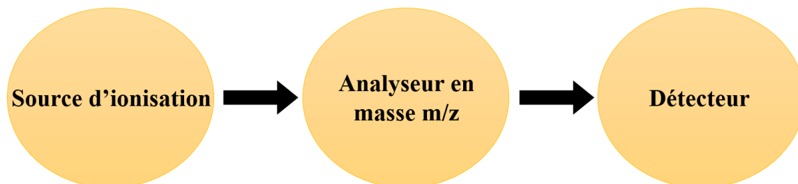
FIGURE 1.22 – Structure d'un spectromètre de masse.
