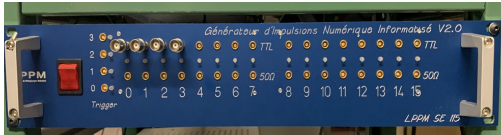
FIGURE 2.8 – Photographie du Générateur d'impulsions numérique informatisé.
