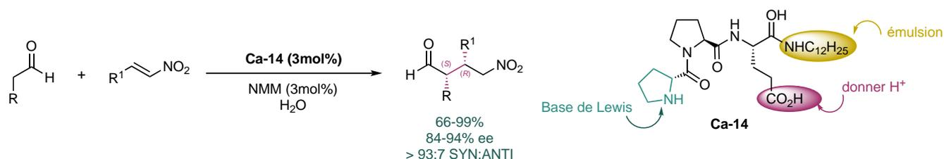
Schéma 33 : Catalyse de la réaction d'addition de Michael dans l'eau par un peptide amphiphile
