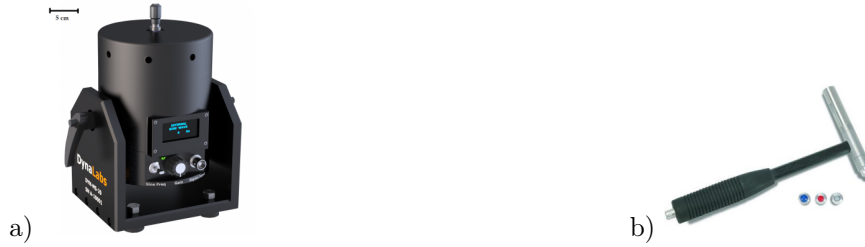
FIGURE 1.2 – Illustration de systèmes d’excitation utilisés dans le cadre de l’AME : pot vibrant (a) et marteau d’impact (b) (Image : alliantech.com et usinenouvelle.com)
