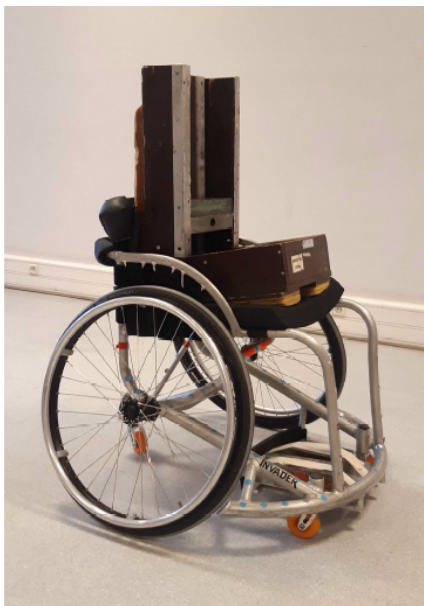
FIGURE 2 – Photographie du mannequin d'essai chargé à 36 kg utilisé sur le FRM de basket
