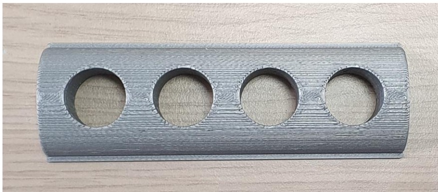
Figure 12 : Support de fixation des blocs "Prothèses" pour l'acquisition d'images au micro-CT.
