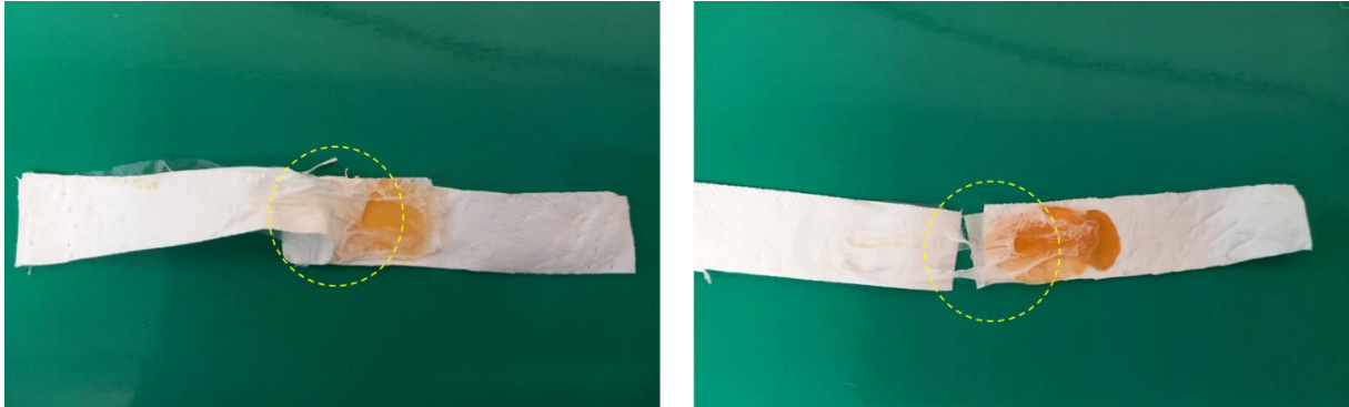
Figure 110 : Éprouvettes après essai de pelage, sur lesquelles un déchirement d'une couche est observé.
