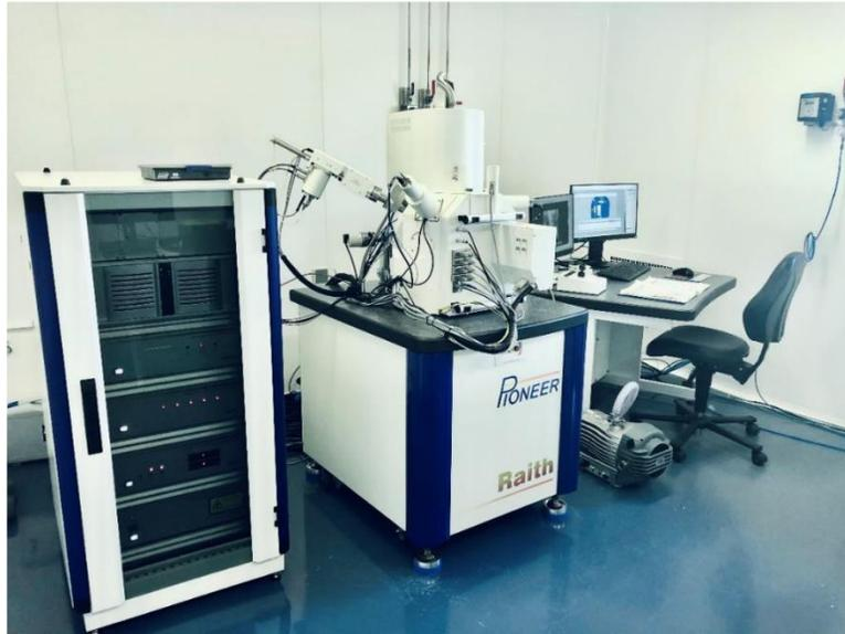
Figure 3.2.3 : Photographie du système de lithographie électronique à balayage RAITH de la Centrale de Proximité en Nanotechnologies de Paris Nord.
