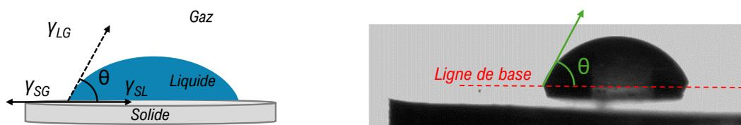
Figure 35 : Schéma de principe de mesure d'angle de contact apparent
