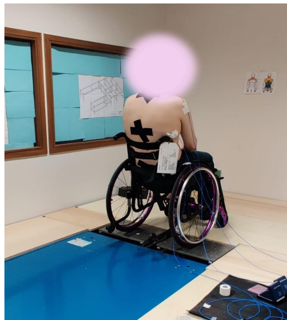
Figure 34 : Installation expérimentale d'un participant en FRM, équipé de capteurs accélérométriques (assise, L5, T6, C7), sur le banc d'essai vibratoire : Bibrate
