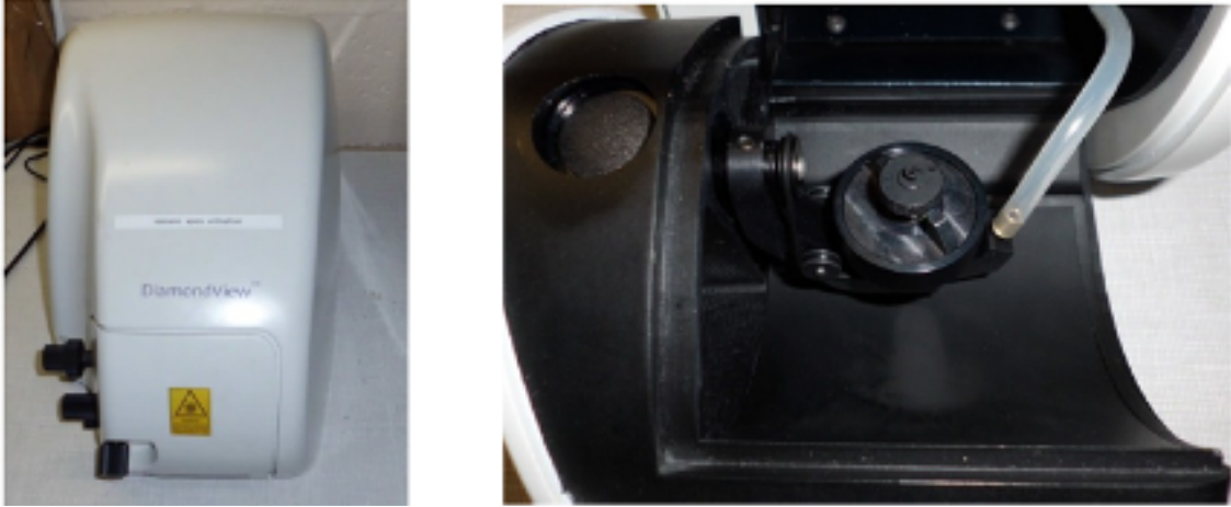
Figure 32 : Photographies (a) de l'extérieur et (b) de l'intérieur du dispositif DiamondView™
