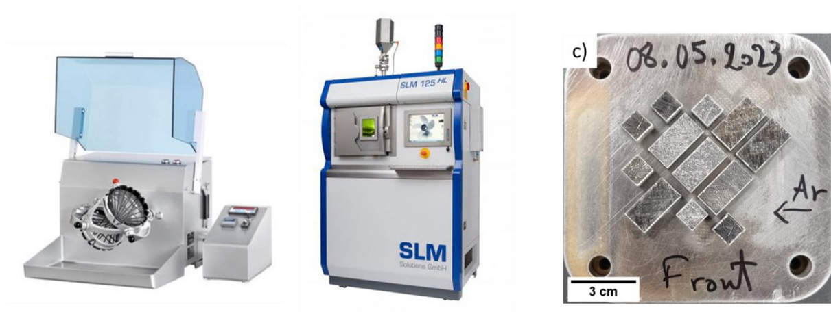
Figure 2.2: a) mélangeur dynamique 6 axes turbula T2C, b) machine SLM 125 HL, c) échantillons en sortie de machine sur le plateau d'impression
